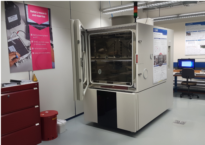
Klimakammer zur Untersuchung von Batteriezellen am CSEM in Neuenburg. Die Temperatur kann zwischen -45^{\circ}\text{C} und +180^{\circ}\text{C} eingestellt werden. Die Klimakammer hilft dabei, die Batteriezellen unter kontrollierten Umweltbedingungen zu testen. Alle Tests im Rahmen des BAT4SEL-Projekts wurden bei 20^{\circ}\text{C} durchgeführt. Foto: CSEM
