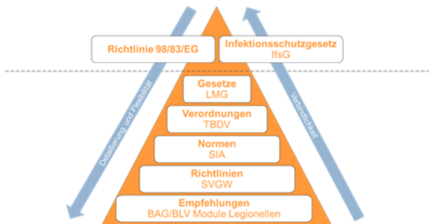
Abb. 7. Von Fachleuten im Baugewerbe üblicherweise vermutete und praktisch angewendete Hierarchie von Gesetzgebung, Normen, Richtlinien und Empfehlungen.
