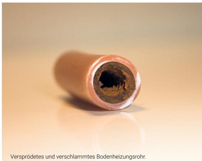
Versprödetes und verschlammtes Bodenheizungsrohr.
