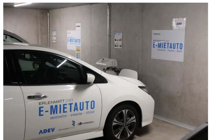
Die Batterien des Nissan E-NV200 Evalia und des Nissan Leaf können Solarstrom zwischenspeichern. Zu diesem Zweck kann der Bereich zwischen 30 und 90 % Ladestand genutzt werden. Foto: B. Vogel
