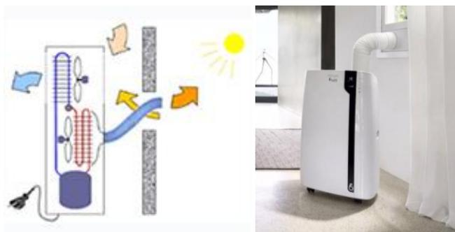
Abbildung 3: Links: Schematische Darstellung der Funktionsweise eines Einkanal-Systems. Quelle: Brunner, Steinemann, & Nipkow, 2008. Rechts: Abbildung eines mit einem Fensteradapter installierten Systems. Quelle: De'Longhi Appliances S.r.l..
