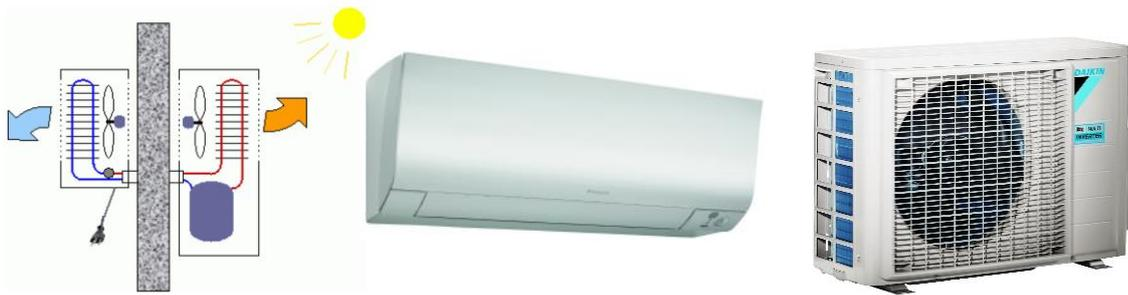
Abbildung 5: Links: Schematische Darstellung der Funktionsweise eines Split-Systems. Quelle: Brunner, Steinemann, & Nipkow, 2008. Rechts: Abbildungen eines Innenraum- und Aussenraumgerätes. Quelle: Daikin Industries, Ltd..
