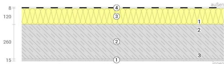
Abbildung 44: Aufbau des Daches.
