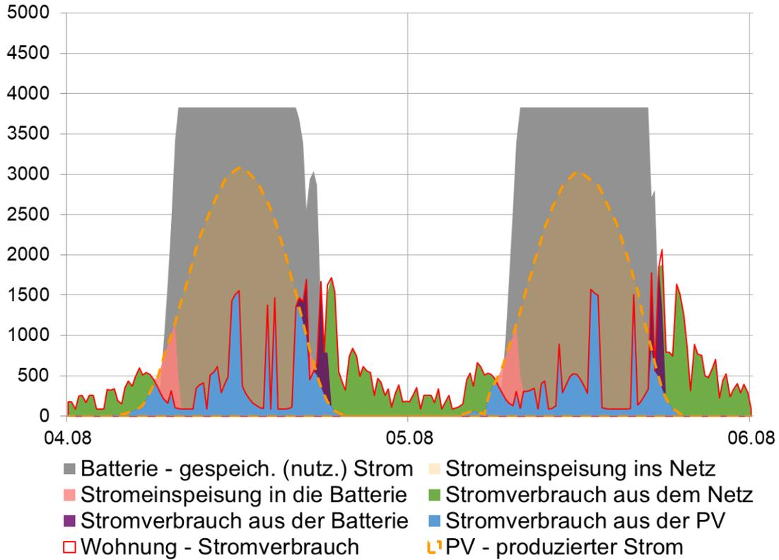
Abbildung 64: Erzeugter Strom aus der Photovoltaikanlage, Stromverbrauch der gesamten Wohnung aus der Photovoltaikanlage mit Batteriespeicher vom 4. bis 6. August für das wärmste Jahr der Referenzperiode (2003).
