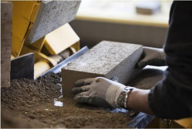
Abb. 88: Pressen eines Steines. © Terrabloc SA
