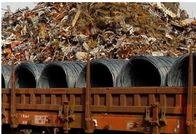
Abb. 83: Armierungsstahl wird in der Schweiz häufig aus Stahlschrott gewonnen. © Stahl Gerlafingen AG
