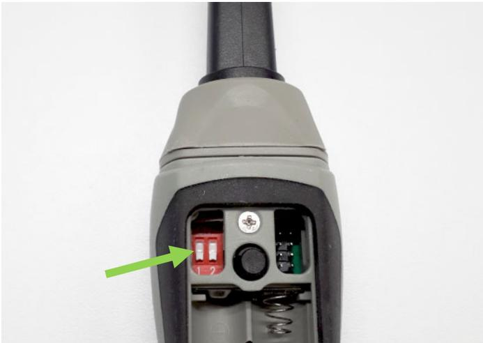
Abb. 10: Schieber zum Abstellen der Auto-Off Funktion (grüner Pfeil) beim Messgerät von Testo.
