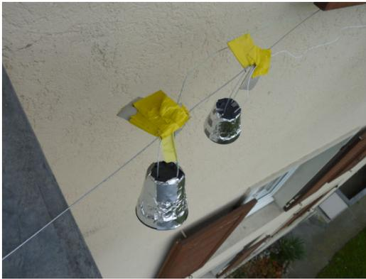
Abb. 6: Schutzgehäuse für die Aussentemperaturfühler.
