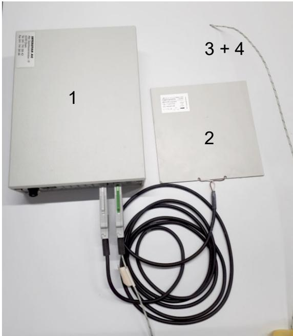
Abb. 4: Messgerät von Ahlborn: 1 = Datenlogger, 2 = Wärmeflussplatte, 3 = Fühler Innentemperatur,  $\theta_i$ , 4 = Es muss mindestens noch ein Fühler für die Aussentemperatur,  $\theta_e$ , angeschlossen werden (gleiche Optik, auf Abbildung nicht dargestellt).
