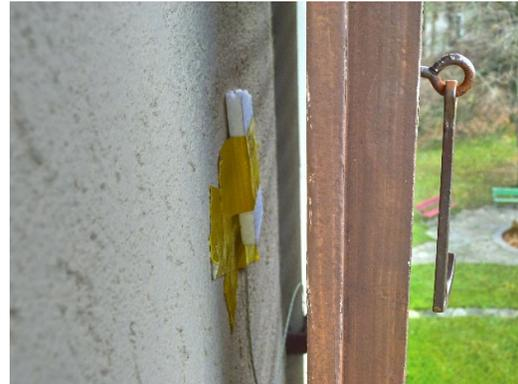
Abb. 11: Abdeckung für die Messung der Wandoberflächentemperatur aussen
