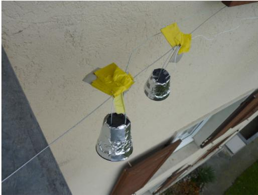
Abb. 10: Strahlungsschirm für die Aussentemperaturfühler.
