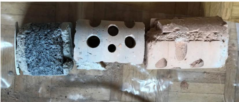
Abb.6: Kernbohrung Mauerwerkswand 3. OG. Zusätzlich zu den Ziegelsteinen ist (schwarz) ca. 5 cm Hochofenschlacke im Aufbau vorhanden. Quelle Bild: Okan Sevim, Ferrara Architekten AG
