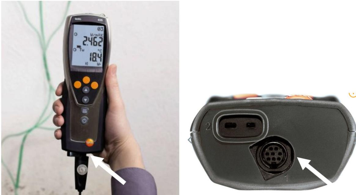
Abb. 8: Messgerät Testo und Unterseite mit Position Lufttemperaturfühler (Pfeil), Quelle (ohne Pfeil): Testo.
