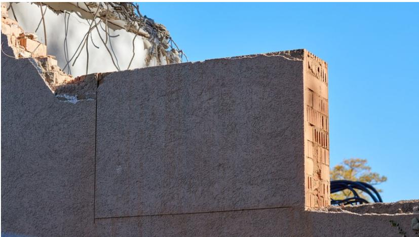
Abb. 5: Prüfkörper Mauerwerk, die Schnittkanten sind sauber, leider sind in den Eckbereichen oben jeweils Putzstücke abgebrochen.
