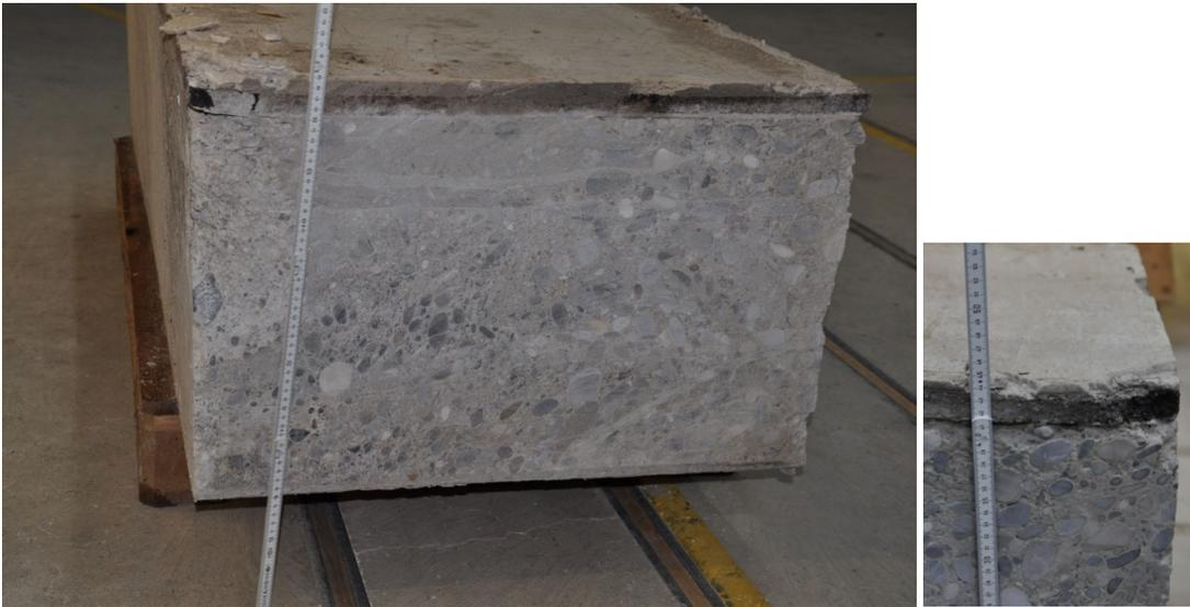
Abb. 7: Prüfkörper Beton, die Innenseite ist oben. Gut zu erkennen ist die ca. 1.6 cm starke Dämmschicht, welche aus Kork besteht (Quelle Bilder: BFH).
