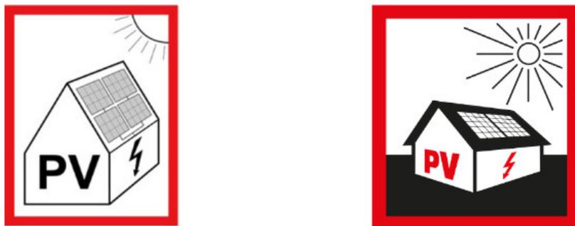
Abbildung 56: Hinweisschilder für Photovoltaik-Anlagen (Quelle und mehr Info zur Kennzeichnung: Swissolar 2017).
