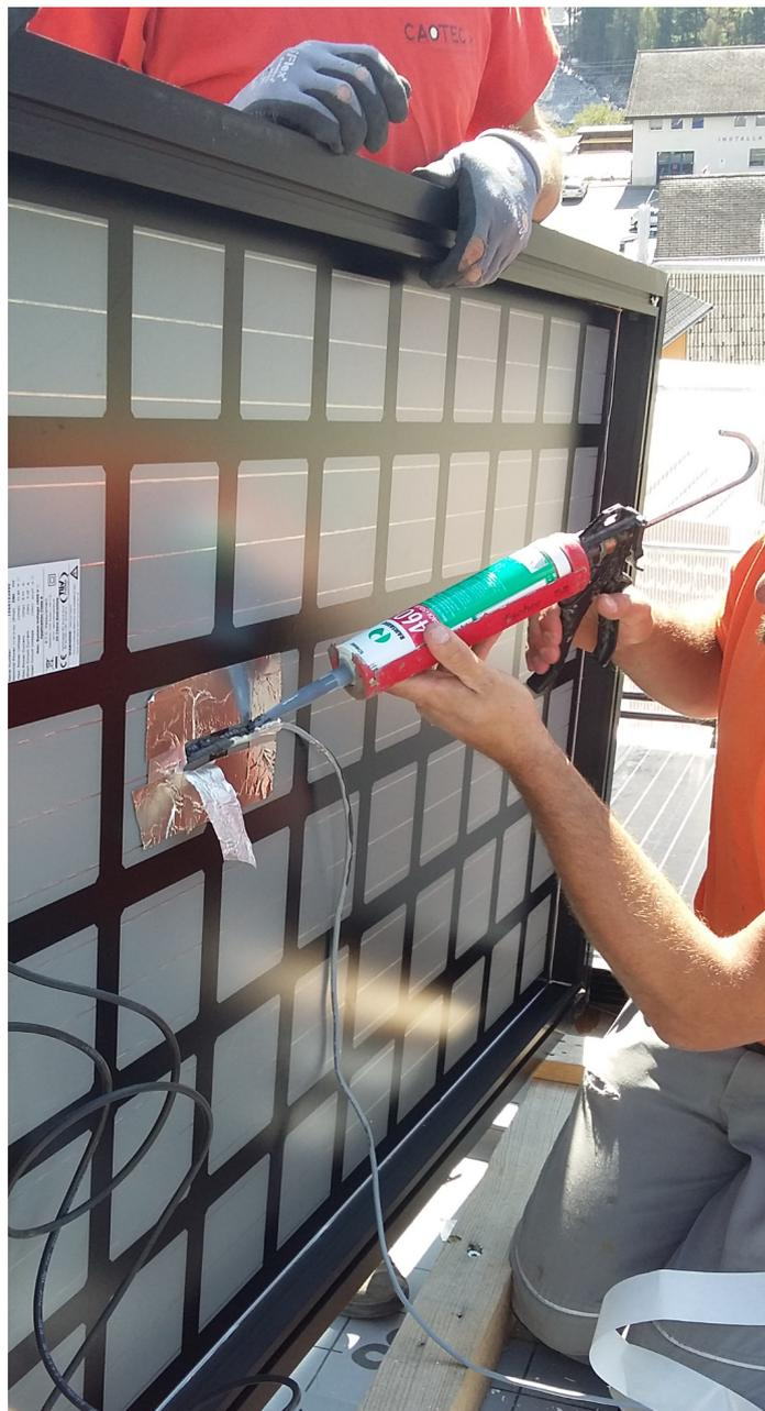
Für das Forschungsprojekt rüsten SPF-Forscher die Rückseite eines PV-Moduls mit einem Temperaturfühler aus. Foto: BFE-Schlussbericht
