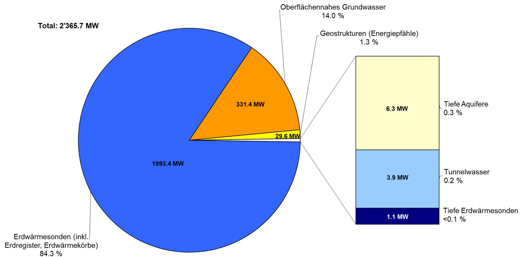
Figur 6: Diagramm mit Anteilen der **installierten Heizleistung** (nur Wärmepumpen-Anlagen, ohne Direktnutzung) aufgeschlüsselt für WP-Systeme im Jahr 2020.
