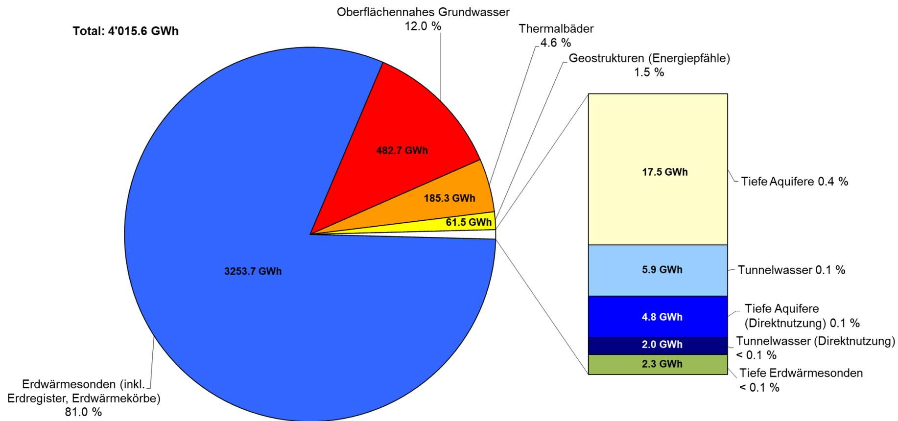
Figur 7: Diagramm mit Anteilen der **Heizenergie** aller geothermischen Systeme im Jahr 2020.
