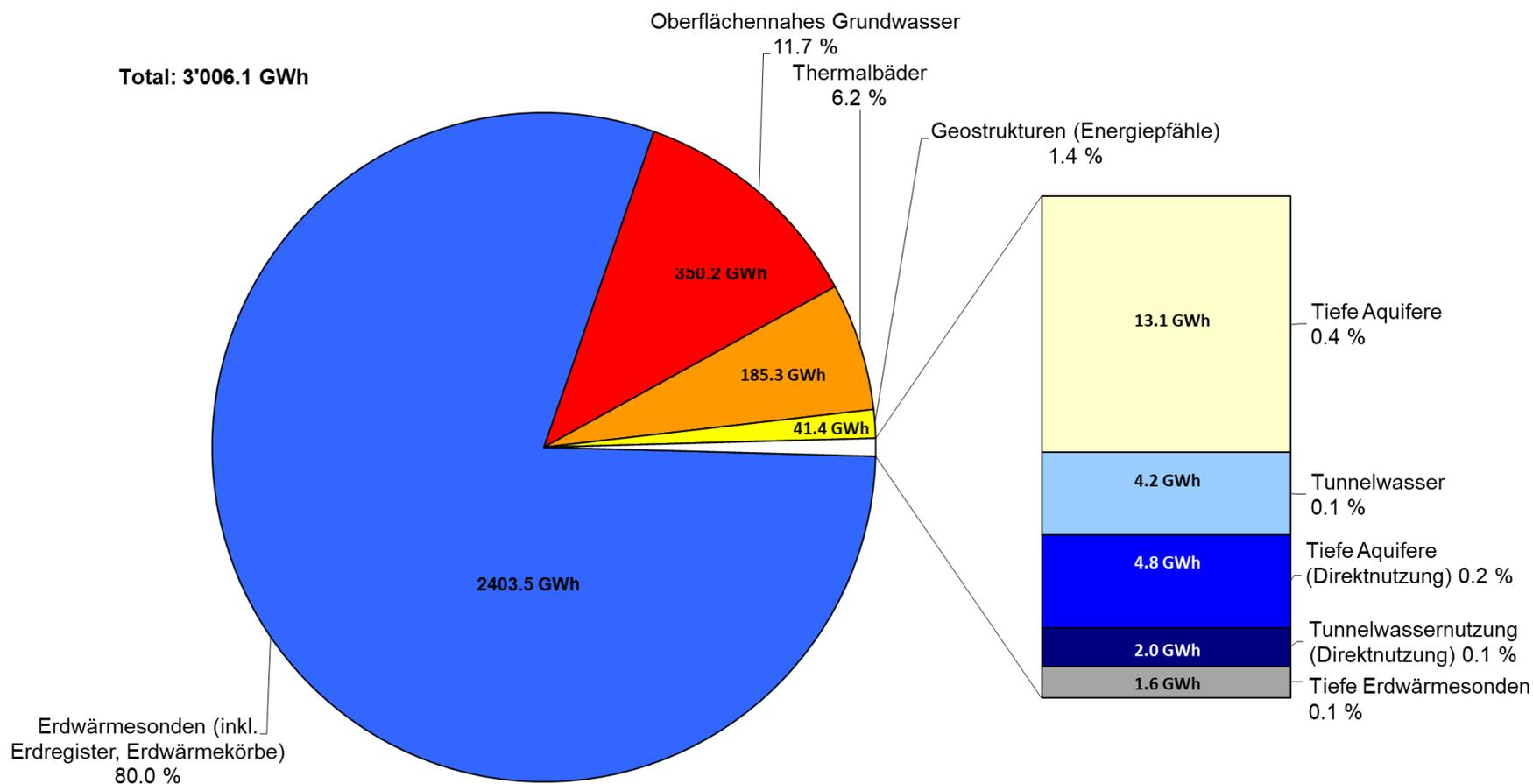
Figur 8: Diagramm mit Anteilen der geförderten **geothermischen (erneuerbaren) Energie** aller geothermischen Systeme im Jahr 2020.
