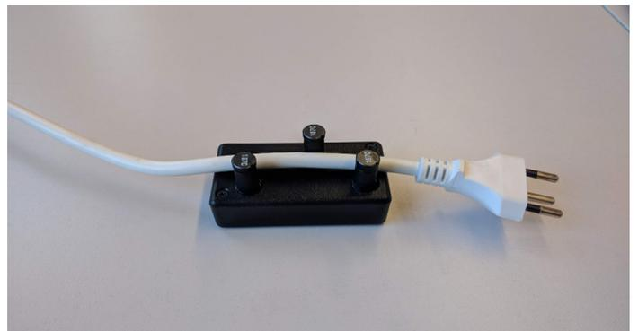
Mit diesem selbst entwickelten On-Off-Detektor stellten HSLU-Forscher im SmartNIALMeter-Projekt fest, ob das angeschlossene Elektrogerät eingeschaltet war oder nicht, ohne dass das Anschlusskabel dazu zuvor ausgesteckt oder aufgetrennt werden musste. Foto: Schlussbericht SmartNIALMeter
