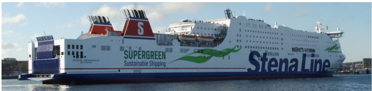
Abbildung 5: Im Jahr 2015 wurde eine zwischen Kiel und Göteborg eingesetzte Fähre auf Dual-Fuel-Betrieb umgebaut und fährt seither teilweise mit Methanol (rund 25 %), um Emissionsgrenzwerte einhalten zu können.
