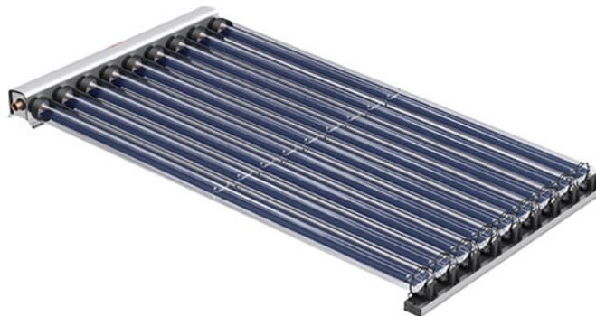
Abbildung 25: Beispiel eines Vakuumröhren-Solarwärmekollektors des Heatpipe-Typs. Er besteht aus evakuierten Glasröhren, in denen jeweils ein Absorberstreifen platziert ist, welcher die Solarstrahlung in Wärme umwandelt und über ein Wärmeträgerfluid an den Sammelkanal oben am Kollektor abgibt. Bild: Viessmann AG.
