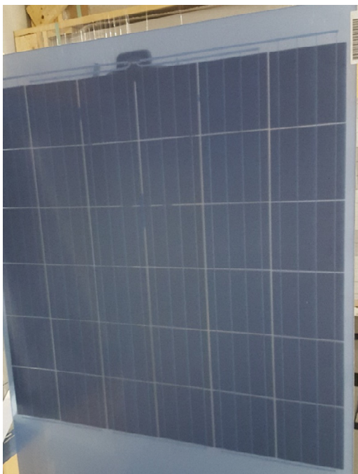
Abbildung 9: Glas/Glas-Modul mit blauer PVB-Folie (Quelle: KIOTO Photovoltaics GmbH)
