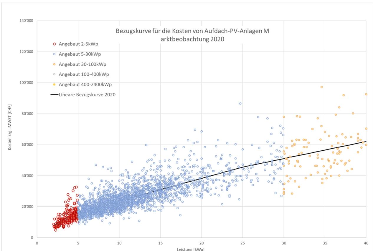
Abbildung 25: Kosten zzgl. MWST in Abhängigkeit der Leistung, Detaildarstellung des Bereichs 2 bis 40 kWp. Die schwarze Kurve unten ist das Minimum (Excel-Formel «MIN») der fünf oben parametrisch angegebenen Kurven Ax+B.
