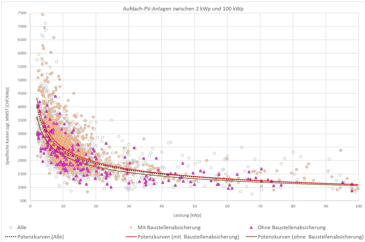
Abbildung 15: Vergleich der spezifischen Kosten von Anlagen, bei denen die Baustellenabsicherung eingeschlossen ist, mit jenen, bei denen dies nicht der Fall ist. Die grauen Kreise stehen für alle Aufdach-PV-Anlagen und beinhalten auch Anlagen, für die keine Angaben zur Baustellenabsicherung vorliegen.
