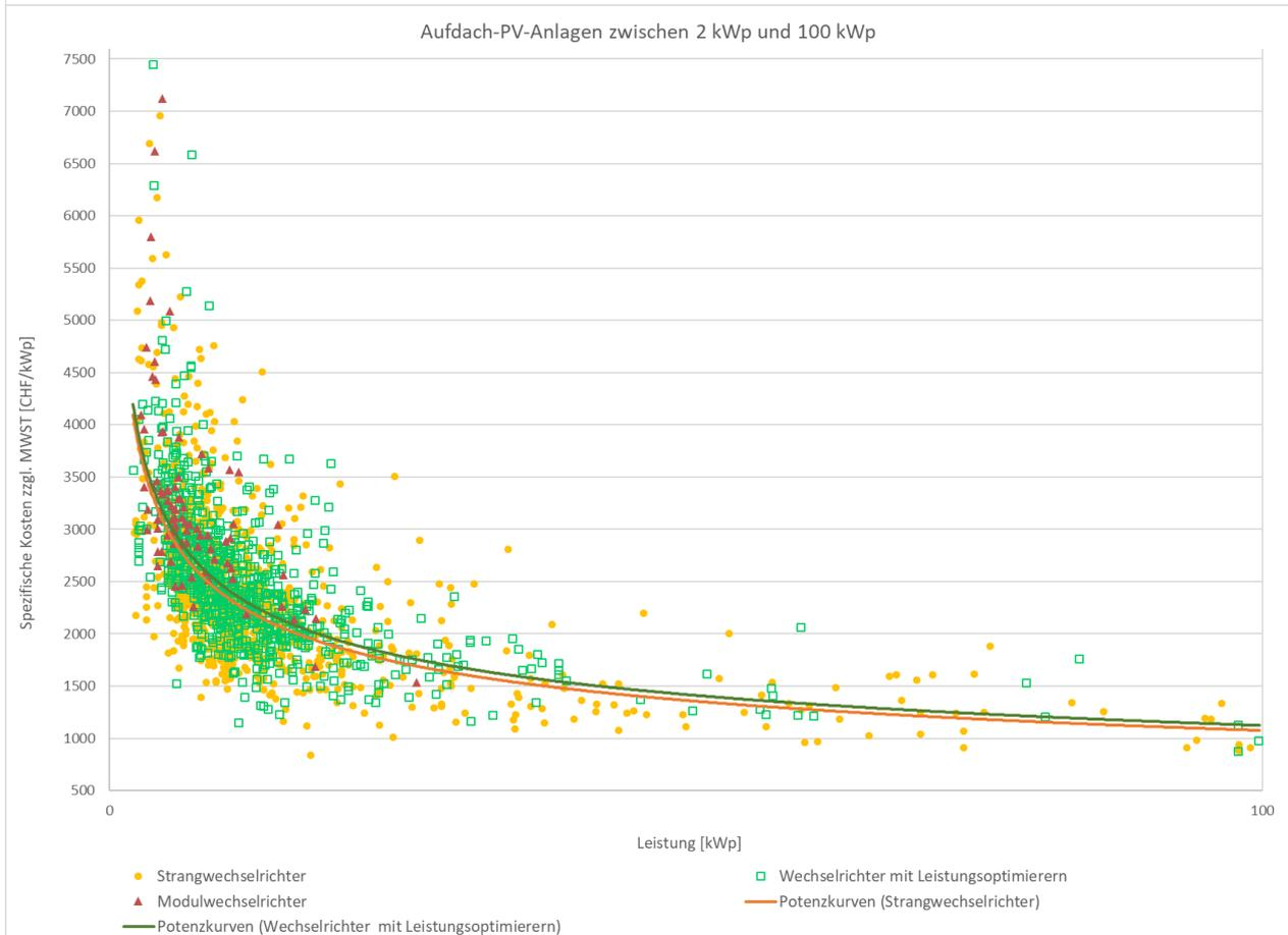
Abbildung 17: Vergleich der spezifischen Anlagenkosten in Abhängigkeit von der Art des/der offerierten bzw. installierten Wechselrichter(s) gemäss Offerte bzw. Rechnung. Datenpunkte von Modulwechselrichtern sind ausschliesslich im unteren Leistungsbereich zu finden. Trendlinien (Potenzkurven) mittels Excel erstellt.
