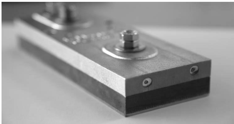
Abbildung 20: Querschnitt mehrschichtiger Tiegelboden mit Blockheizung
