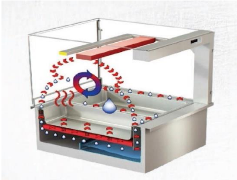
Abbildung 34: Unterbau mit Dampfgenerator
