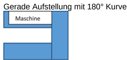
Abbildung 50: Korbtransport-Spülmaschinen Gerade Aufstellung mit 180° Kurve
