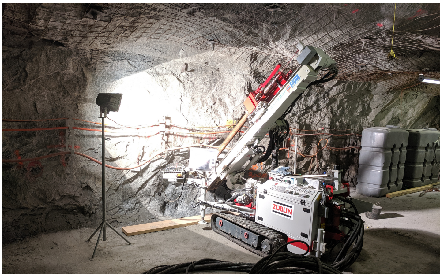
Das Bohrgerät treibt eine mehrere Hundert Meter lange Bohrung von 22 cm Durchmesser in den Granit des Gotthardmassivs, in der die Wissenschaftlerinnen und Wissenschaftler der ETH Zürich danach ihre Messgeräte einführen. Foto: Schweizerischer Erdbebendienst an der ETH Zürich, 2019
