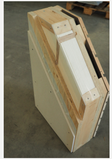
Ein Wandelement mit Steinwollen-Dämmung (links) ist deutlich breiter als das Element mit Aerogel-Dämmung. Fotos: Martin Gruber
