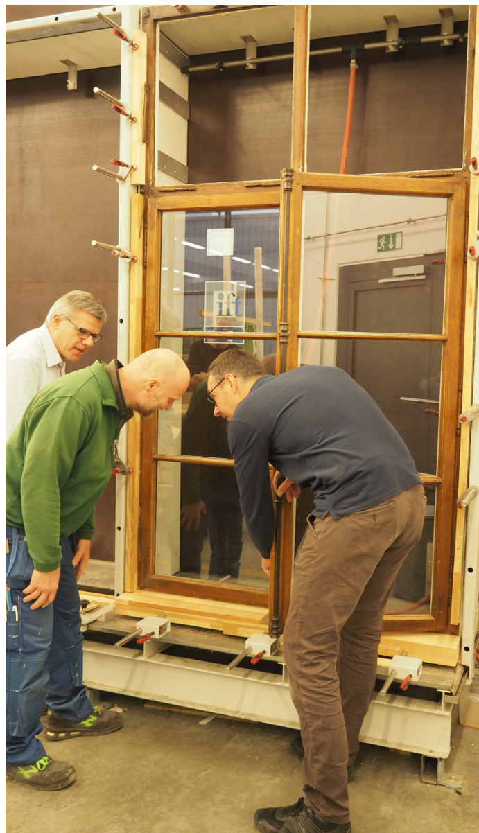
An einem denkmalgeschützten Haus in Basel wurde die energetische Sanierung der historischen Fenster evaluiert. Durch Einbau eines Vakuumisolierglases unter Erhalt der historischen Fensterrahmen kann die Wärmedämmung um einen Faktor 3 verbessert werden (Senkung des U-Werts von 4.9 auf 1.5). Foto: Martin Gruber
