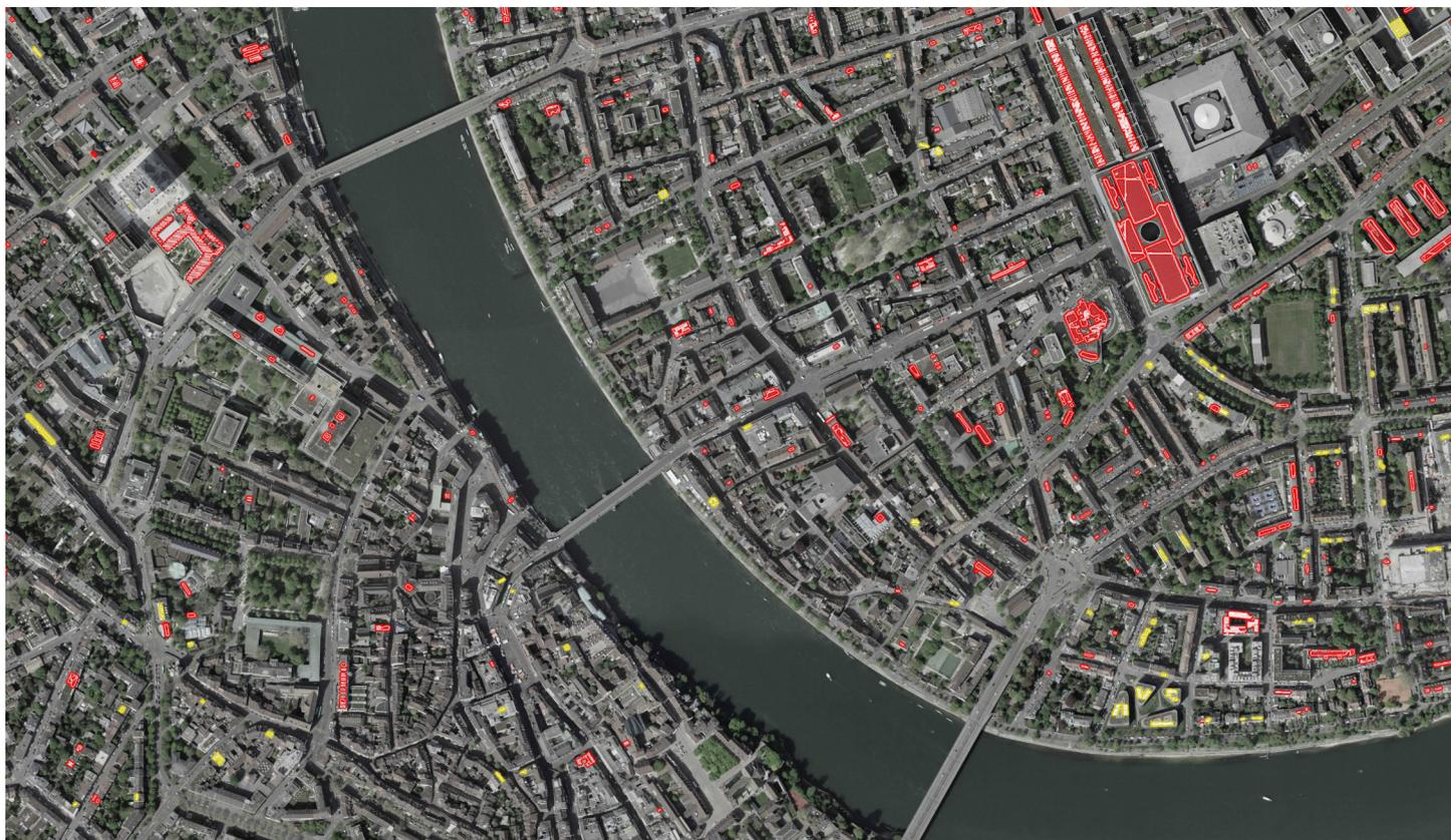
Erkannt durch künstliche Intelligenz: Die PV-Anlagen (rot) und die solarthermischen Anlagen (gelb) im Zentrum der Stadt Basel. Rechts oben das mit Photovoltaik ausgestattete Dach des Messekomplexes. Foto: FHNW
