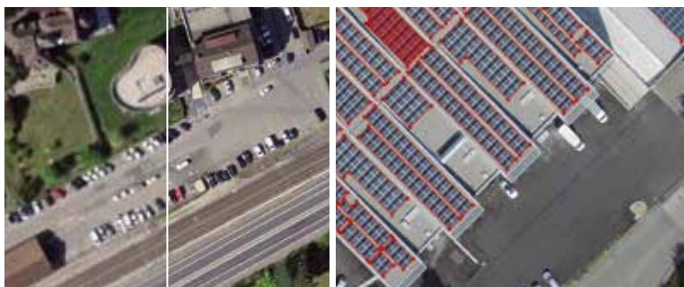
Entscheidende Voraussetzung für die Erkennung von Solaranlagen auf Luftbildern ist eine entsprechend hohe Auflösung. Das Bundesamt für Landestopographie swisstopo liefert hierzu neu Aufnahmen mit 10 cm Auflösung. Das Bild links illustriert das im Vergleich zur bisherigen Auflösung von 25 cm (linker Bildteil). Um das neuronale Netzwerk zu trainieren, wurden insgesamt 7839 Bilder präpariert, wo Photovoltaik- und thermische Anlagen mit Polygonen markiert wurden (Quelle: FHNW).
