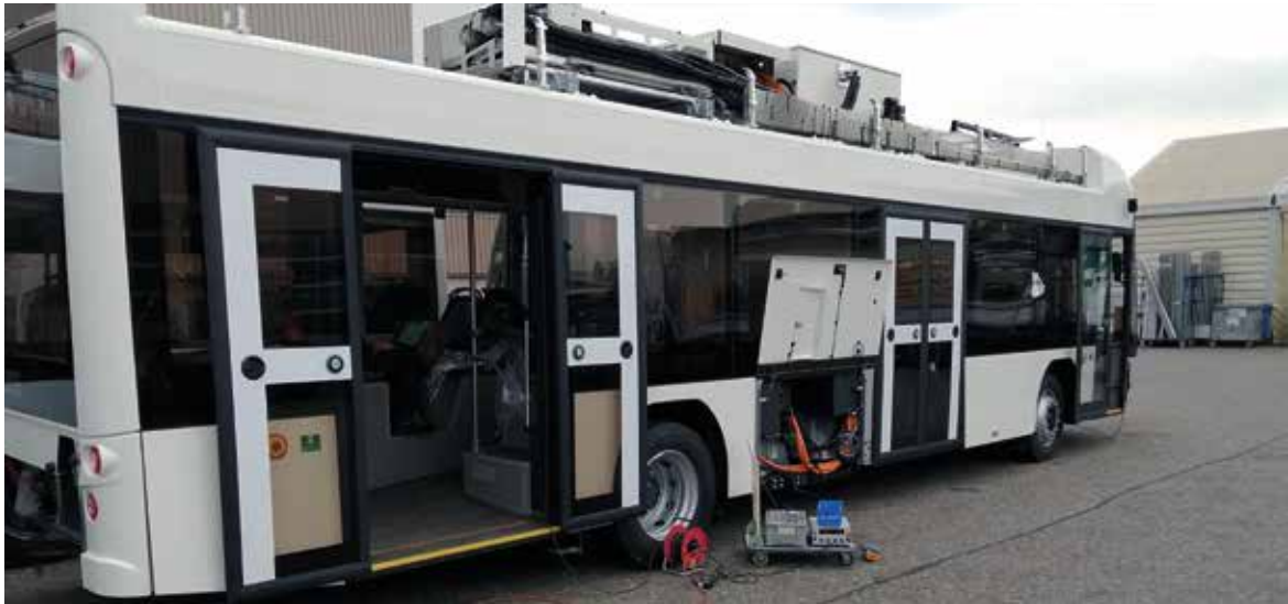
Wichtige Kostenpositionen bei elektrisch angetriebenen Bussen und Nutzfahrzeugen sind der Antriebsstrang und der Energiespeicher. Im Rahmen eines Pilotprojektes soll eine Flotte von batterieelektrischen Bussen mit einem neuen auf Siliziumkarbid (SiC)-Halbleitern basierenden Stromrichter ausgerüstet werden, der direkt in den Motor integriert wird. Die Effizienz des Stromrichters hat unmittelbaren Einfluss auf die benötigte Batteriekapazität und so indirekt wieder auf die Systemkosten (Bildquelle: ABB).
