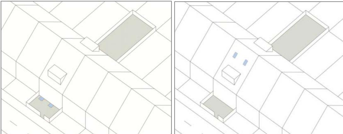
*Bild 10: Vom öffentlichen Stadtraum aus sichtbare Luftgitter innen aufgestellter Luft/Wasser-Wärmepumpen im Erdgeschoss (links) und Dachbereich (rechts).*
