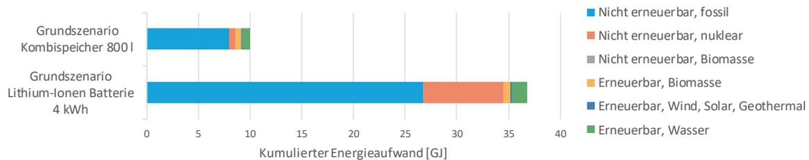
Bild 5: Vergleich des kumulierten Energieaufwands für einen Kombispeicher und eine Lithium-Ionen-Batterie für 4 kWh Stromspeicheräquivalent
