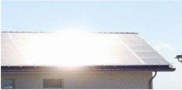
Abbildung 7: Blendwirkung eines Schrägdachs. Deutlich sichtbar ist die Bündelauflösung, dadurch erkennbar, dass anstelle des direkten Abbilds der Sonne eine flächige Lichterscheinung sichtbar ist.
