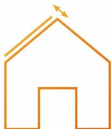
Die Solaranlage darf die Dachfläche im rechten Winkel um höchstens 20 cm überragen. Diese Anforderung erfüllen in das Dach integrierte, aber auch parallel zur Dachfläche montierte Anlagen.
