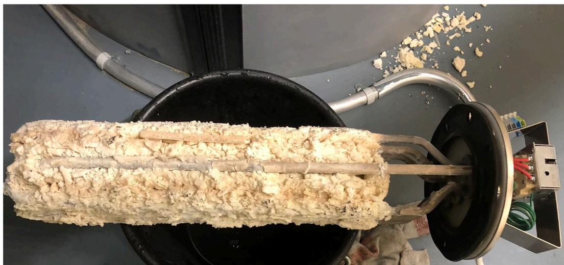
Abbildung 29: Komplett verkalkter Heizstab nach keiner kompletten Heizperiode
