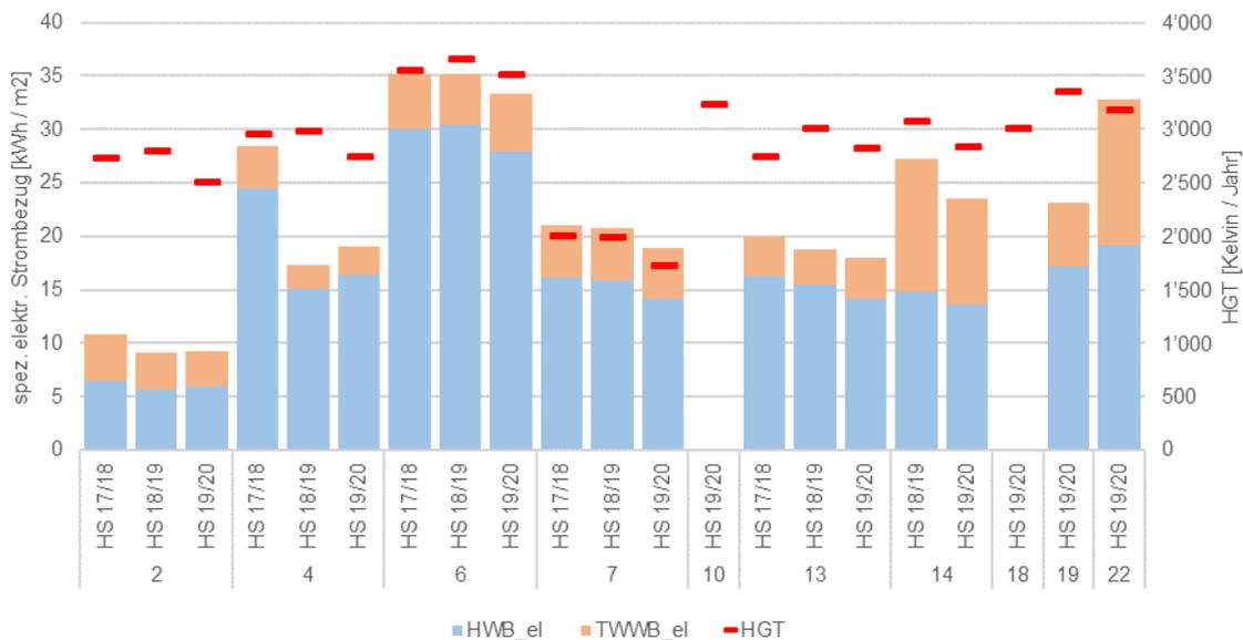
Abbildung 15: Darstellung des elektrischen Strombezugs für Heizen und Trinkwarmwassererzeugung pro m2, sowie der Heizgradtage aller Sole/Wasser-Wärmepumpenanlagen
