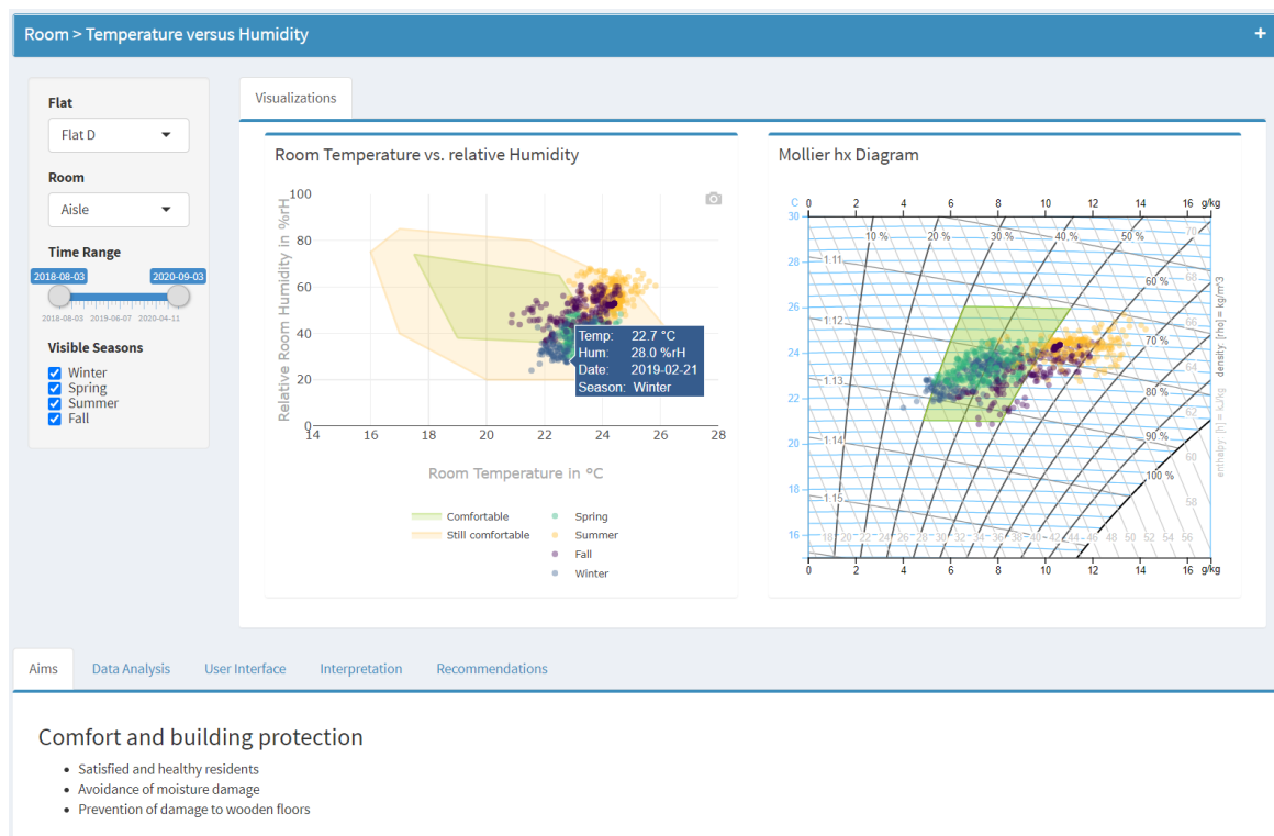
Abbildung 12. Modul Room > Temp vs. Hum (Screenshot). Mit diesem Modul wird eine Komfortanalyse bezüglich Feuchte und Temperatur vorgenommen. Quelle: Hochschule Luzern.
