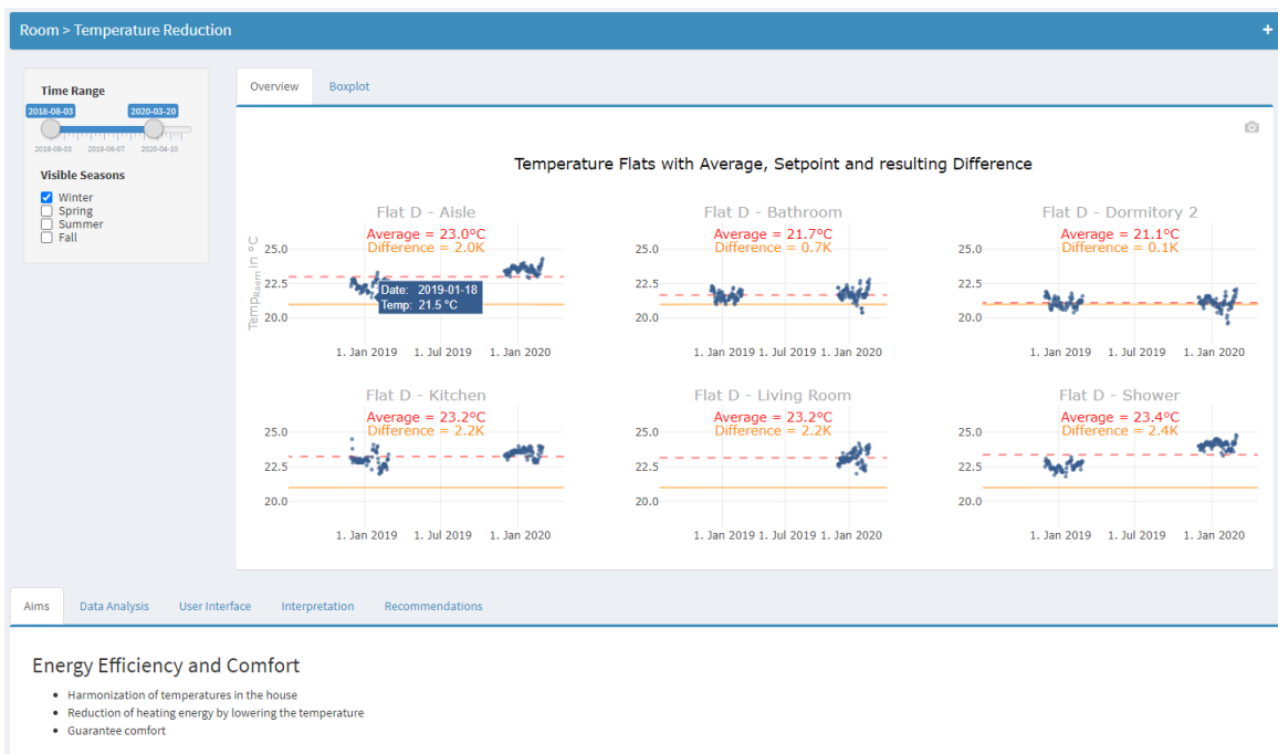
Abbildung 15. Modul Room > Temp Reduction (Screenshot). Mit diesem Modul wird die tatsächliche Raumtemperatur überwacht mit dem Ziel, diese einem vorgegebenen Sollwert anzugleichen. Quelle: Hochschule Luzern.
