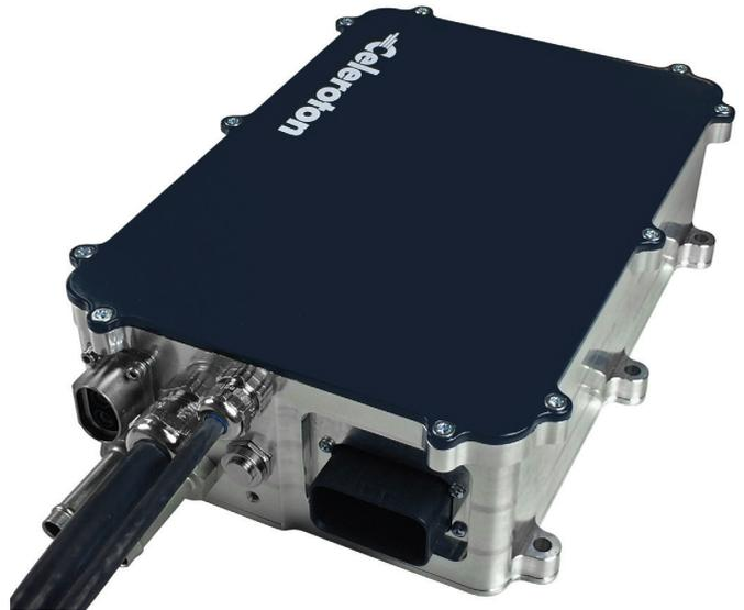
Integrierte Kompressor-Elektronik (Umrichter CC-550-7500), wie sie in einem 60 kW-Brennstoffzellensystem zum Einsatz kommt, wo drei Komponenten zusammengefasst werden. Damit kann der Energieverbrauch des Verdichters um geschätzt 10% gesenkt werden. Foto: Celeroton
