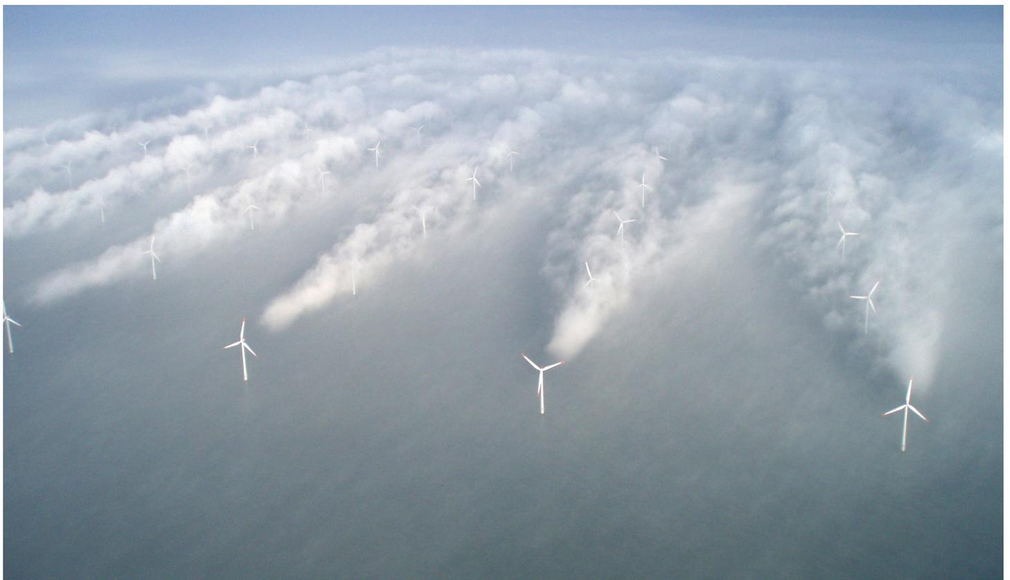
Ein Schnappschuss der besonderen Art: Aufgrund besonderer Wetterverhältnisse wird die Nachlaufströmung der Windkraftwerke in einem dänischen Offshore-Windpark durch Kondensation sichtbar. Foto: Vattenfall/Christian Steiness
