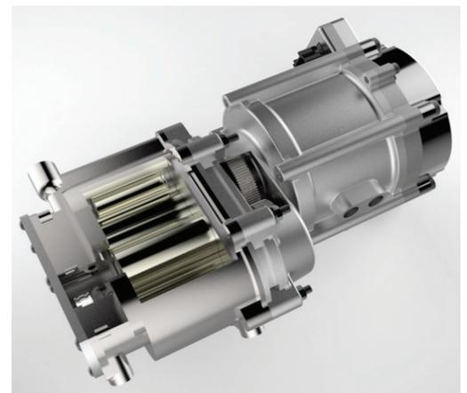
Die FPT-Forscher verwenden eine von Eaton entwickelte Pumpe zur Abgasrückführung (Foto). Ihr Energiebedarf kann den Verbrauch des Motors um bis zu 0,5% erhöhen. Allerdings ist in gewissen Betriebszuständen des Motors der Druck auf der Abgasseite des Motors höher als auf der Ladeseite. In diesem Fall kann mit der Pumpe der Energieverbrauch sogar reduziert werden. Foto: Eaton
