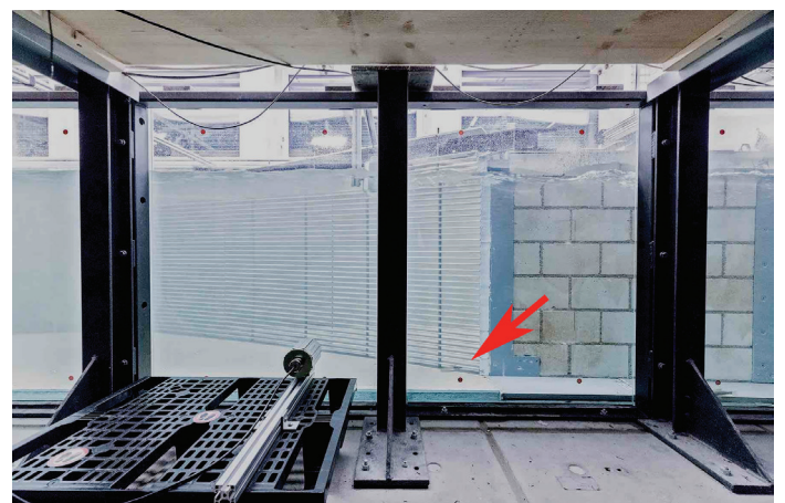
Eine Kamera erfasst im VAW-Labor an der ETH Zürich das Verhalten von Fischen am Leitrechen. Rechts unten am Rechen (markiert mit Pfeil) ist eine Barbe zu sehen, die gegen das von links anströmende Wasser schwimmt und durch die horizontalen Stäbe des Rechens zu schlüpfen droht. Foto: VAW
