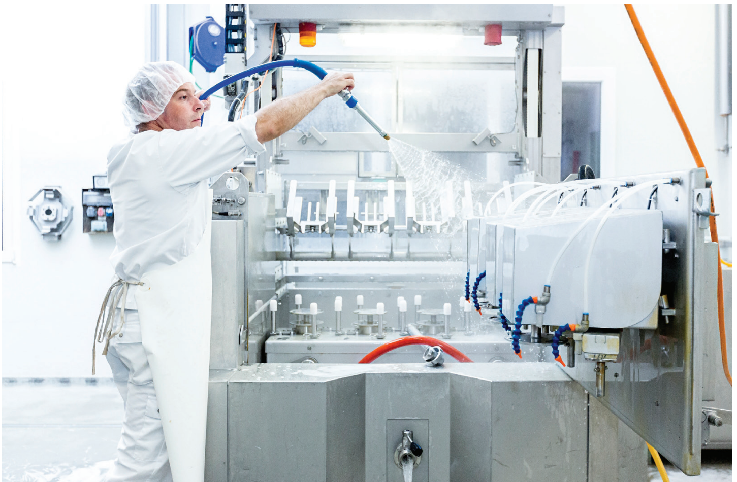
Die Milchindustrie (im Bild: Emmi-Werk in Emmen, Kanton Luzern) braucht heisses Wasser unter anderem zur Reinigung von Tanks und Produktionsanlagen. Das heisse Wasser kann zumindest teilweise durch Solarkollektoren bereitgestellt werden. Foto: Emmi
