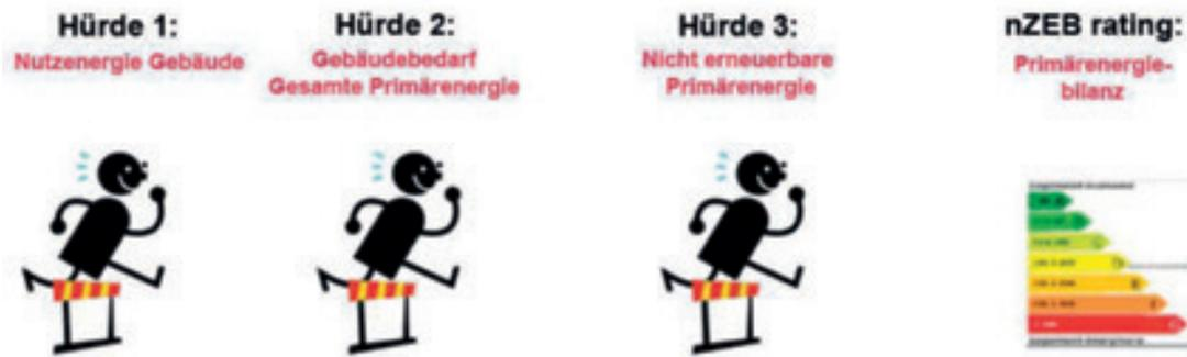
*Bild 2: Hürdenlauf nach EN 15603 als harmonisierter Ansatz für nZEB in der EU*
