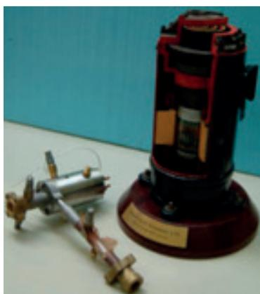
**Bild 4:** Vergleich zwischen dem gasgelagerten Proof-of-Concept Radialverdichter und einem äquivalenten Scrollverdichte [12]
