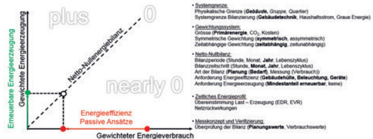
**Bild 1: Prinzip von nZEB (links) und häufig benutzte Kriterien (rechts)**
