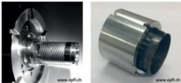
**Bild 3: Beispiele eines 10mm Spiralrillenlagers für 280'000U/Min für den 1kW Verdichter (links) und eines an der EPFL hergestellten 40mm Folienlagers für 60'000U/Min**
