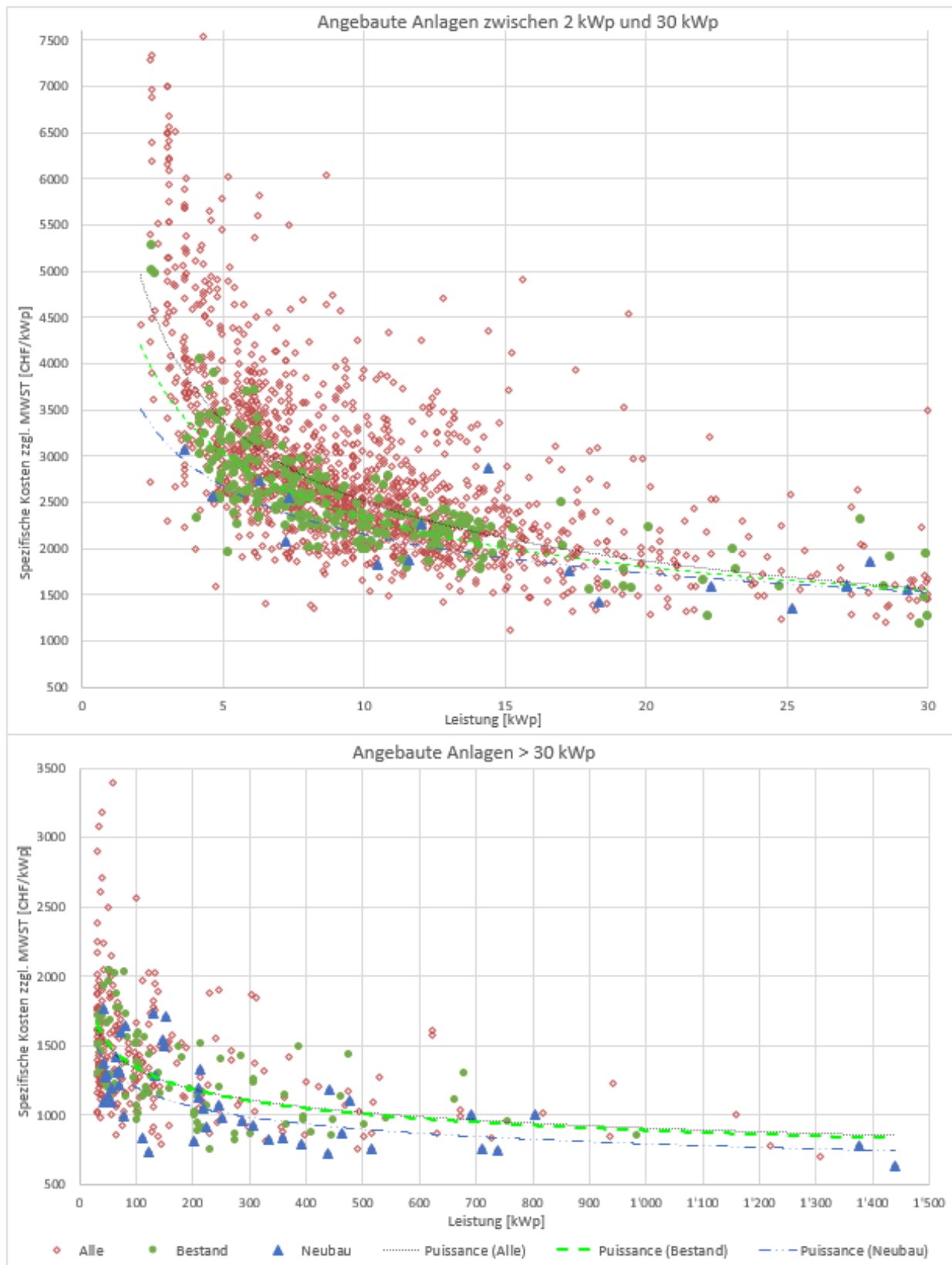
Abbildung 14: Vergleich der spezifischen Kosten von Anlagen auf bestehenden und Anlagen auf neuen Gebäuden. Die ungefüllten roten Rauten stehen für alle angebaute Anlagen, für die keine Angaben zur Gebäudeart vorliegen. Oben die Daten für 2 bis 30 kWp, unten jene für > 30 kWp. Trendlinien (Potenzkurven) mittels Excel erstellt.
