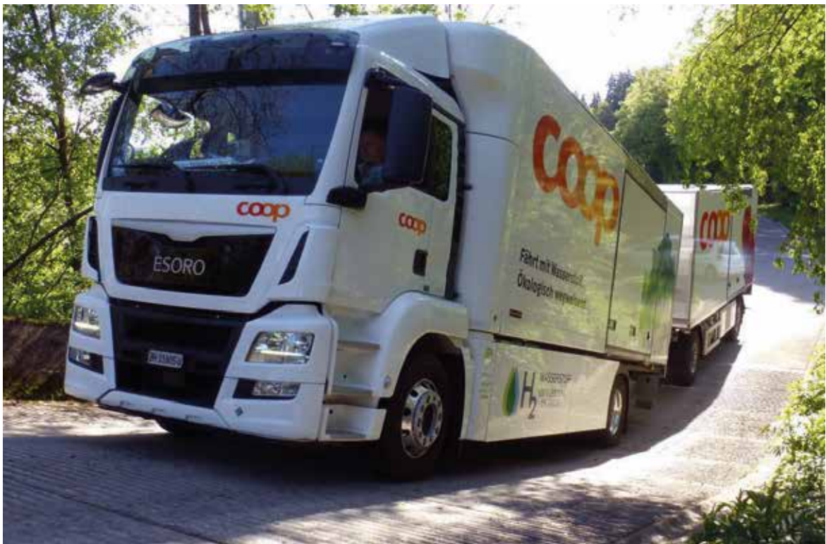
Prototypen-Brennstoffzellenlastwagen entwickelt von der Firma Esoro in Zusammenarbeit mit Swiss Hydrogen: Erfolgreicher Anfahrversuch bei einer Steigung von 30 % und einem Gesamtgewicht (Lastwagen plus Anhänger) von 35 Tonnen (Quelle: Esoro).
