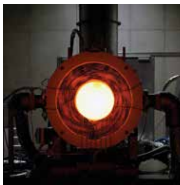
Neuartiges Solar-Receiver-Konzept der Firma Synhelion AG mit Strahlungsübertragung an Gas als Wärmeträger (Grafik nach Synhelion). Ein 200 kW-Pilotreaktor (Quelle: Synhelion) wurde 2019 am Solarsimulator des Deutschen Zentrums für Luft- und Raumfahrt (rechts, Quelle: DLR/M. Hauschild) erfolgreich getestet und es werden Temperaturen von über 1550 °C erreicht.
