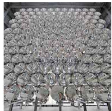
Neuartiges Solar-Receiver-Konzept der Firma Synhelion AG mit Strahlungsübertragung an Gas als Wärmeträger (Grafik nach Synhelion). Ein 200 kW-Pilotreaktor (Quelle: Synhelion) wurde 2019 am Solarsimulator des Deutschen Zentrums für Luft- und Raumfahrt (rechts, Quelle: DLR/M. Hauschild) erfolgreich getestet und es werden Temperaturen von über 1550 °C erreicht.
