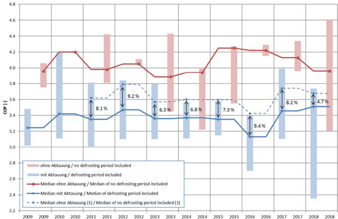
Abb. 1.2: COP-Vergleich zwischen Wärmepumpen mit und ohne Abtauung
