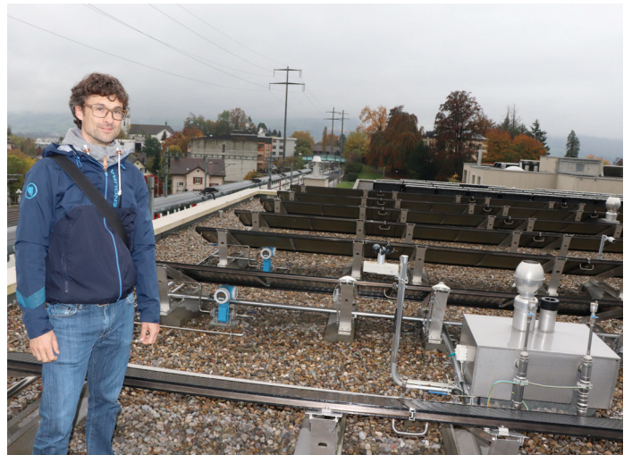
Die unverglasten Solarkollektoren sind standardmässig mit einer rückseitigen Wärmedämmung versehen, die Wärmeverluste bei hohen Temperaturen reduzieren soll. Die SPF-Forscher (im Bild: Projektleiter Daniel Philippen) konnten in ihrer Studie nachweisen, dass ein Verzicht auf die Wärmedämmung die JAZ+ nur unwesentlich verringert, aber den Vorteil hat, dass das Kollektorfeld kleiner – und damit günstiger – gebaut werden kann. Foto: B. Vogel
